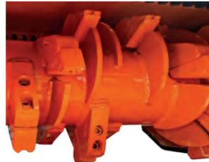
Apeiron-Rotor, feste Zähne mit Wolframbeschichtung und Rotor mit Stahlprofilen.
