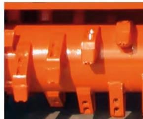
Rotor mit 2-Schrauben-Werkzeug.
