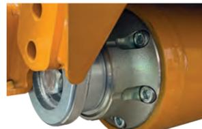
Stützwalze mit großem Durchmesser mit Agri-Disk NG-Flanscheinheiten.
