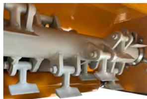
Rotor mit Hammerschlegel
