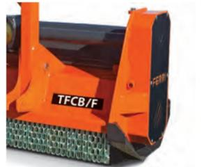
Seitlicher Antrieb mit 4 Riemen und hydraulisch verstellbarer Heckhaube.
