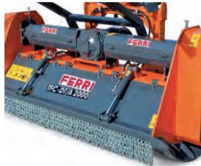
Seitlicher Doppelantrieb mit 5 + 5 Riemen und Hauben mit Zylindern.
